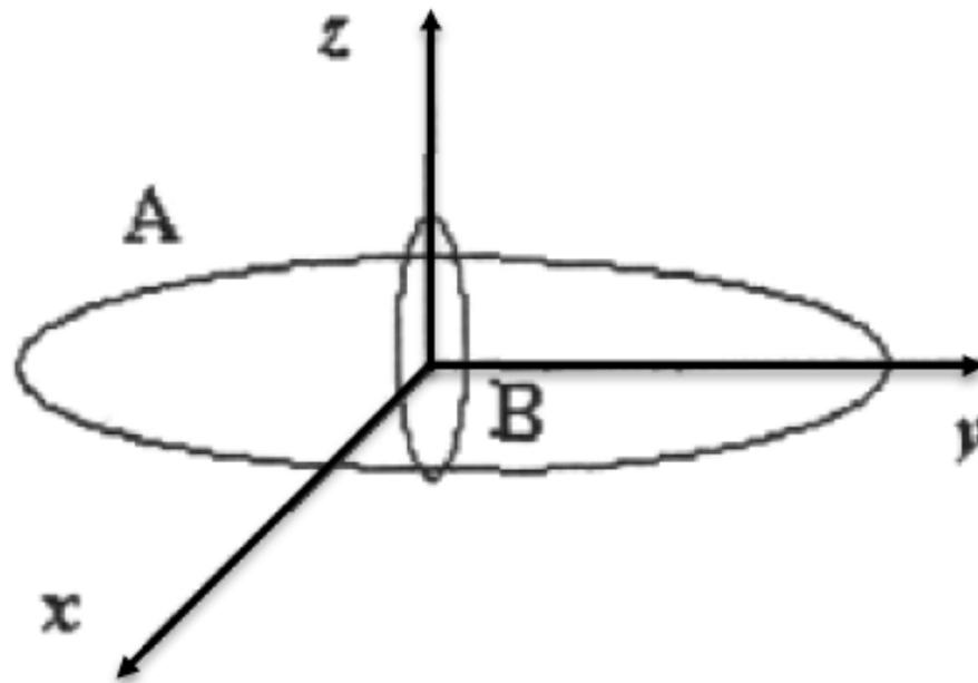
5) Una espira circular (A) de radio  $R_A = 20$  cm yace en el plano  $xy$  y otra, también circular (B), de radio  $R_B = 10$  cm en el plano  $xz$ . Los centros de ambas coinciden con el origen de coordenadas. Determinar las corrientes que deben circular (en módulo y dirección de rotación) por ambas espiras para que el campo magnético en el origen de coordenadas valga  $\vec{B} = -5 \mu\text{T} \hat{j} + 10 \mu\text{T} \hat{k}$ .
